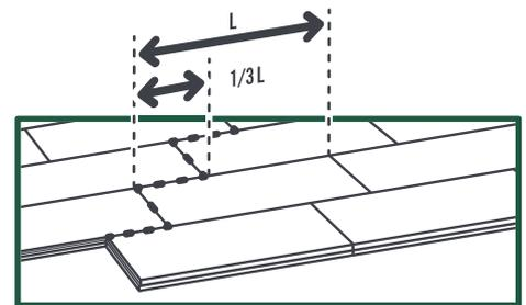
Démarrage de la pose dans un angle de la pièce.
