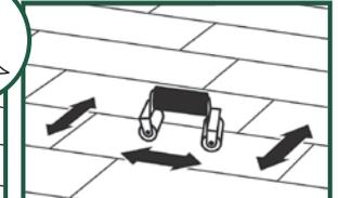
Découper au cutter la lame à remplacer en faisant plusieurs passes sur chaque ligne du tracé, puis retirer délicatement les morceaux de lame. Il est possible d'utiliser une scie circulaire pour faciliter la découpe.
