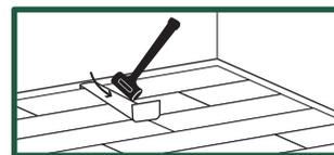
La dernière rangée s'assemble à l'aide d'un tire-lame et un maillet anti-rebond.
