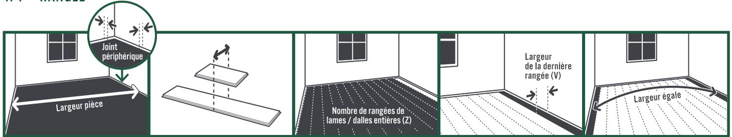
$$X = \text{Largeur pièce} - (\text{joint} \times 2)$$
