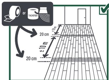
Pour les pièces de grande dimension, poser idéalement le revêtement dans le sens de la longueur de la pièce
