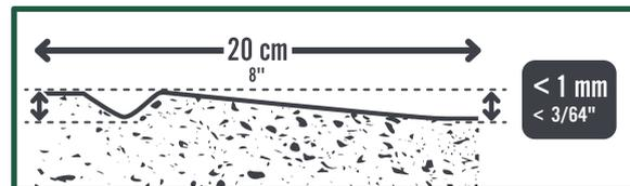
Le support ne doit pas comporter de désaffleurs  $> 1 \text{ mm} / 20 \text{ cm}$ .
